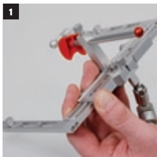
1 Preparación del arco facial. Arco nasal asegurado en posición posterior. Soporte de articulación montado y fijado longitudinalmente con la manilla.
